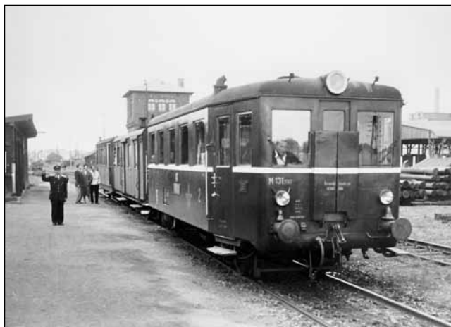
Výpravčí v předpisovém postoji a motorový vlak do Bílovce připravený k odjezdu. Momentka ze Studénky zachycuje soupravu složenou z motorového vozu M131.1167, předválečného přípojněho vozu se zavazadlovým oddílem řady CDlm a o něco novějšího vozu Clm. Snímek pochází z počátku 60. let, o čemž svědčí vpravo za motorovým vozem uložené sloupky trolejového vedení připravené pro elektrizaci stanice. Na bíloveckém nástupišti tehdy ještě stála stará dřevěná čekárna. V pozadí je vidět vodárna bývalé KFNB. Zdroj: sbírka P. Hruďička.
