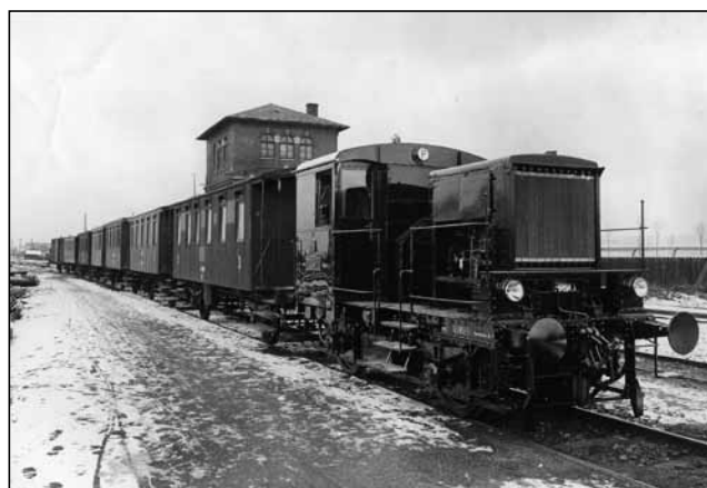
Provozní fotografie z předválečného období jsou nedostatkovým zbožím. Proto alespoň jedna rarita z té doby. Motorová lokomotiva T200.103, vyrobená vagonkou ve Studénce v roce 1932, vyfotografovaná na bíloveckém nástupišti ve Studénce při zkušební jízdě. Již od počátku výroby motorových vozů a lokomotiv v druhé polovině 20. let využívala vagonka bíloveckou i štramberskou trať ke zkouškám svých nových vozidel. Zdroj: Vagonka Studénka, sbírka M. Leštinský.
