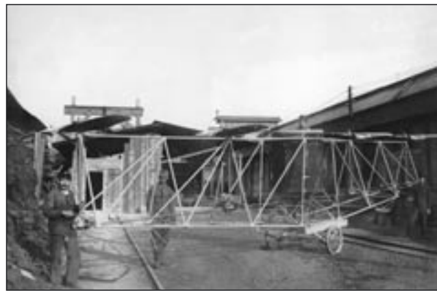
Drak konkurenčního stroje Ing. Theodora Karmána (bez motoru).
