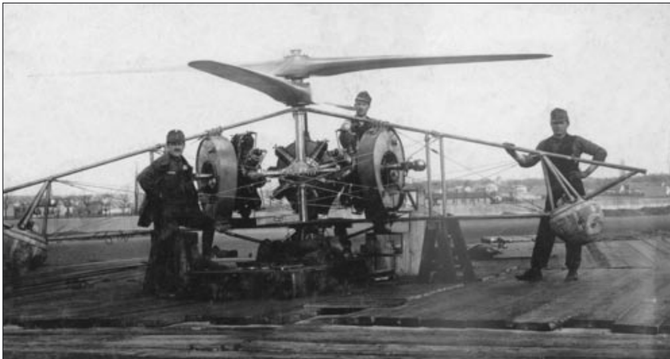
Obsluha připravuje vrtulník ke startu. Stroj je umístěn na přistávacím vaku. Jsou patrné tři hvězdicové motory, před nimi jsou upevněny plechové palivové nádrže vejčitého tvaru. Vrtulník na této fotografii nemá pozorovací gondolu.
