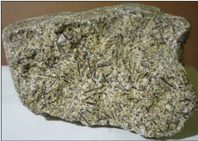
1. Těšinit s charakteristickými jehlicovitými vyrostlicemi amfibolu. Velikost vzorku 11,5 x 7 x 7,5 cm.
